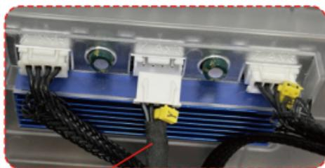
Kabel des Y-Achsenmotors
