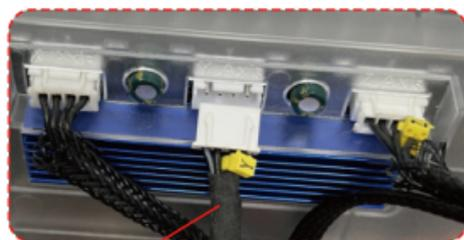
Kabel des Y-Achsenmotors
