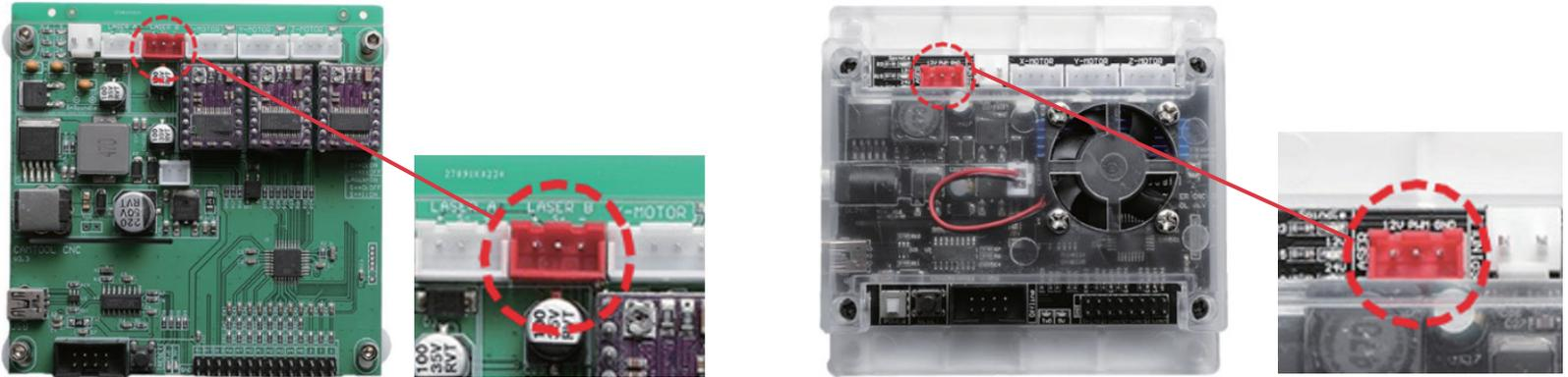
Die obigen Abbildungen zeigen die beiden derzeit im Umlauf befindlichen Varianten der 3018-PRO Steuerungsmodul. In beiden Fällen wird der rote 3-polige Anschluss über ein Kabel angeschlossen, das im Lieferumfang des Moduls enthalten ist und am anderen Ende mit dem roten 3-poligen Anschluss des Laser-Steuermoduls verbunden ist.
