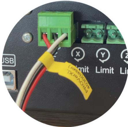
Anschluss des Laser-Steuermoduls an eine PROVerXL 4030 unter Verwendung des 3-poligen Kabels für den GND-, PWM- sowie +12V-Anschluss des Laser-Steuermoduls.
