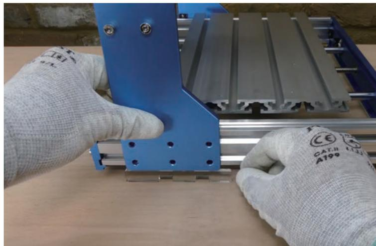
**ステップ 3:** (6)M5 14mmネジでTスロットナットに仮止めします。
